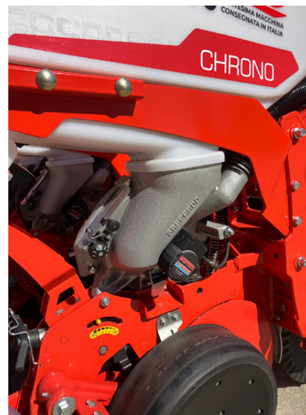
Dosatore di precisione, con motore elettrico e copertura in alluminio
