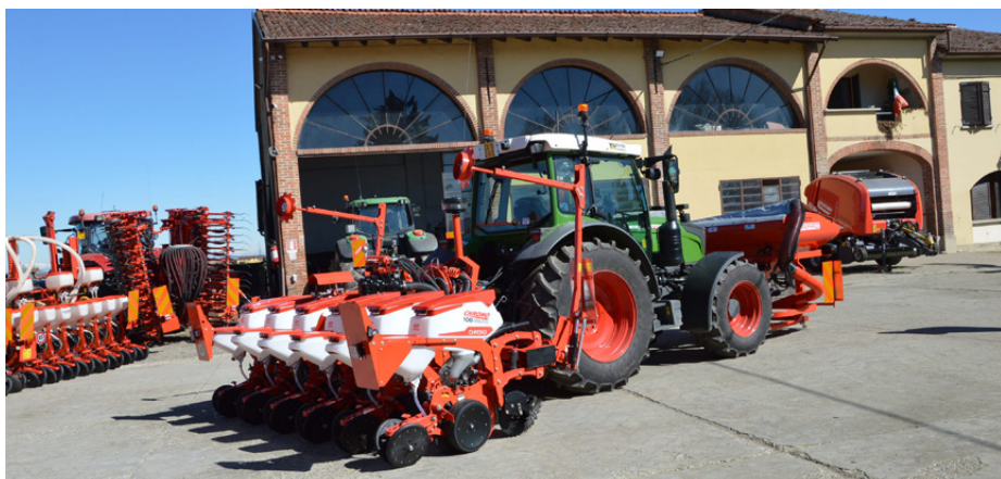
La Chrono 300 abbinata alla tramoggia frontale PA per la distribuzione del concime con distributore elettrico a protocollo di comunicazione Isobus e sistema di trasporto pneumatico
