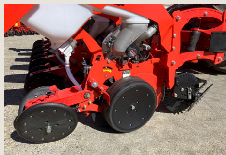
Elemento di semina Chrono ad alta velocità, con controllo pneumatico della pressione al suolo
