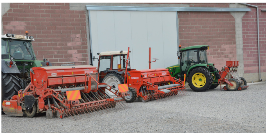
La combinata con Dama ed erpice rotante da tre metri permette di seminare su sodo
