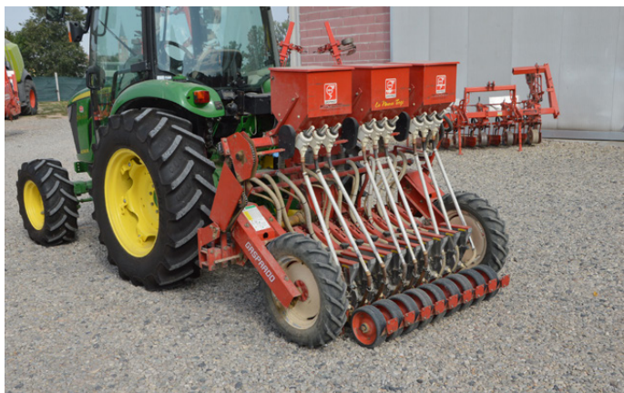
La storica seminatrice per orticole da 9 file con cui i Bolsi hanno conosciuto il marchio Gaspardo
