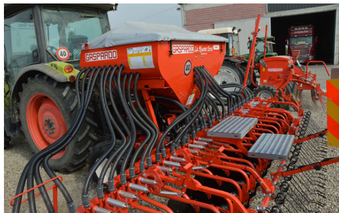
Pinta, ultima arrivata in azienda: una macchina da 40 file, completamente gestita dall'elettronica
