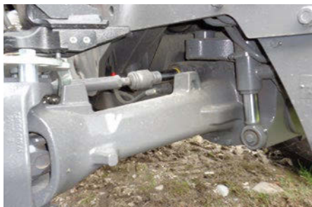
Ponte sospeso realizzato in casa da Massey Ferguson. Progetto riuscito, secondo i proprietari.
