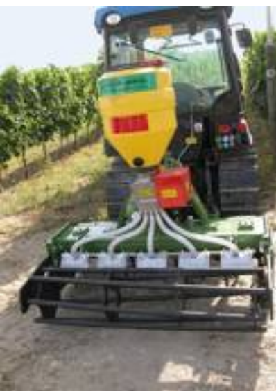
■ Erpice rotante per la lavorazione superficiale e l'interramento dei fertilizzanti.
