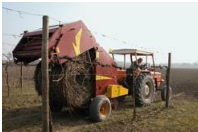
■ Pressatura del legno di potatura in un vigneto.
