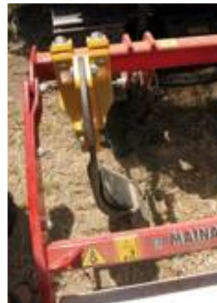
■ Particolare dell'"ancora" di lavoro di un moderno decompattatore.
