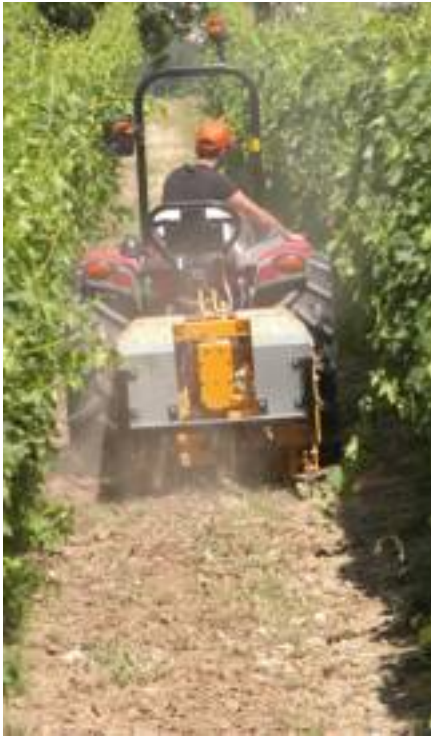
■ Decompattatore vibrante al lavoro.
