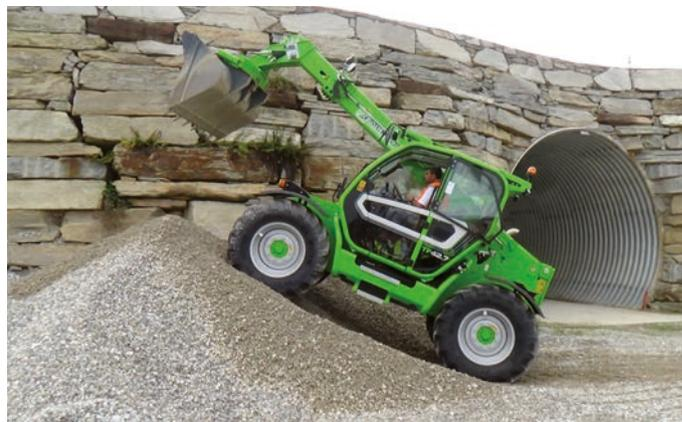
Turbofarmer II alle prese con un test per valutare la capacità di spinta della trasmissione.
