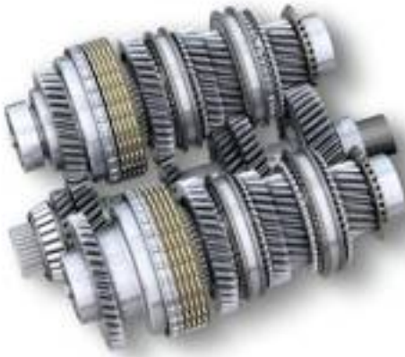
■ Schema della trasmissione Direct Drive installata nel John Deere 6R.
